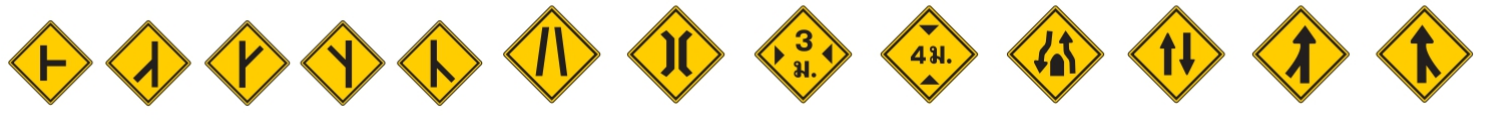
2-16 เครื่องหมายเตือนทางแยก 2-17 เครื่องหมายเตือนทางแยก 2-18 เครื่องหมายเตือนทางแยก 2-19 เครื่องหมายเตือนทางแยก 2-20 เครื่องหมายเตือนทางแยก 2-29 ทางแคบลง 2-30 สะพานแคบ 2-31 จำกัดความกว้าง 2-32 ทางลอดต่ำ 2-41 สิ้นสุดทางคู่ 2-42 รถวิ่งสวนทาง 2-43 ทางร่วม 2-44 ทางร่วม
