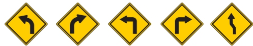
2-1 ทางโค้งซ้าย 2-2 ทางโค้งขวา 2-3 ทางโค้งรัศมีแคบเลี้ยวซ้าย 2-4 ทางโค้งรัศมีแคบเลี้ยวขวา 2-5 ทางโค้งกลับเริ่มซ้าย
